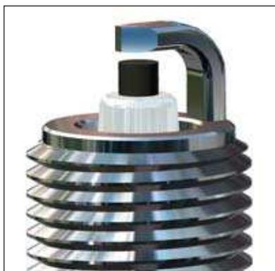
**CZ** Jednoelektrodová širokorozsahová zapalovací svíčka, se střední elektrodou ze slitiny yttria, s velkou odolností proti opalům. Dokonale pokrývá potřeby motoru ve všech provozních režimech. Konstrukční úprava vnější elektrody do tvaru písmene „A“, zlepšuje šíření čela plamene v počáteční fázi a snižuje požadavek na napětí dodávané zapalovacím systémem.
