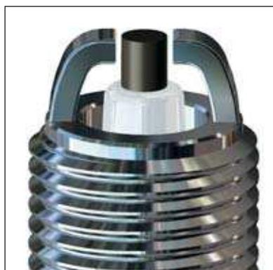
**CZ** Dvouelektrová širokorozsahová zapalovací svíčka, se střední elektrodou ze slitiny yttria, s velkou odolností proti opalům. Otevřené jiskřiště zlepšuje zapálení směsi v počáteční fázi hoření. Dvě vnější elektrody umožňují přeskok jiskry z úsad hoření na špičce izolátoru a eliminují případné nezapálení směsi. Prodloužení intervalu výměny až na **55.000 km**.
