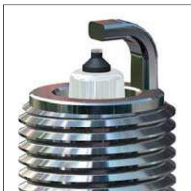
**CZ** Jednoelektrodová širokorozsahová zapalovací svíčka, se střední elektrodou s platinovým kontaktem a vnější elektrodou ze slitiny yttria, umožňující optimalizovat tepelnou bilanci činných částí svíčky tak, že dokonale pokrývá potřeby motoru ve všech jeho provozních režimech po velmi dlouhou dobu. Konstruktivní úprava vnější elektrody, zlepšuje šíření čela plamene a snižuje požadavek na napětí dodávané zapalovacím systémem. Prodloužení intervalu výměny až na **100.000 km**.
